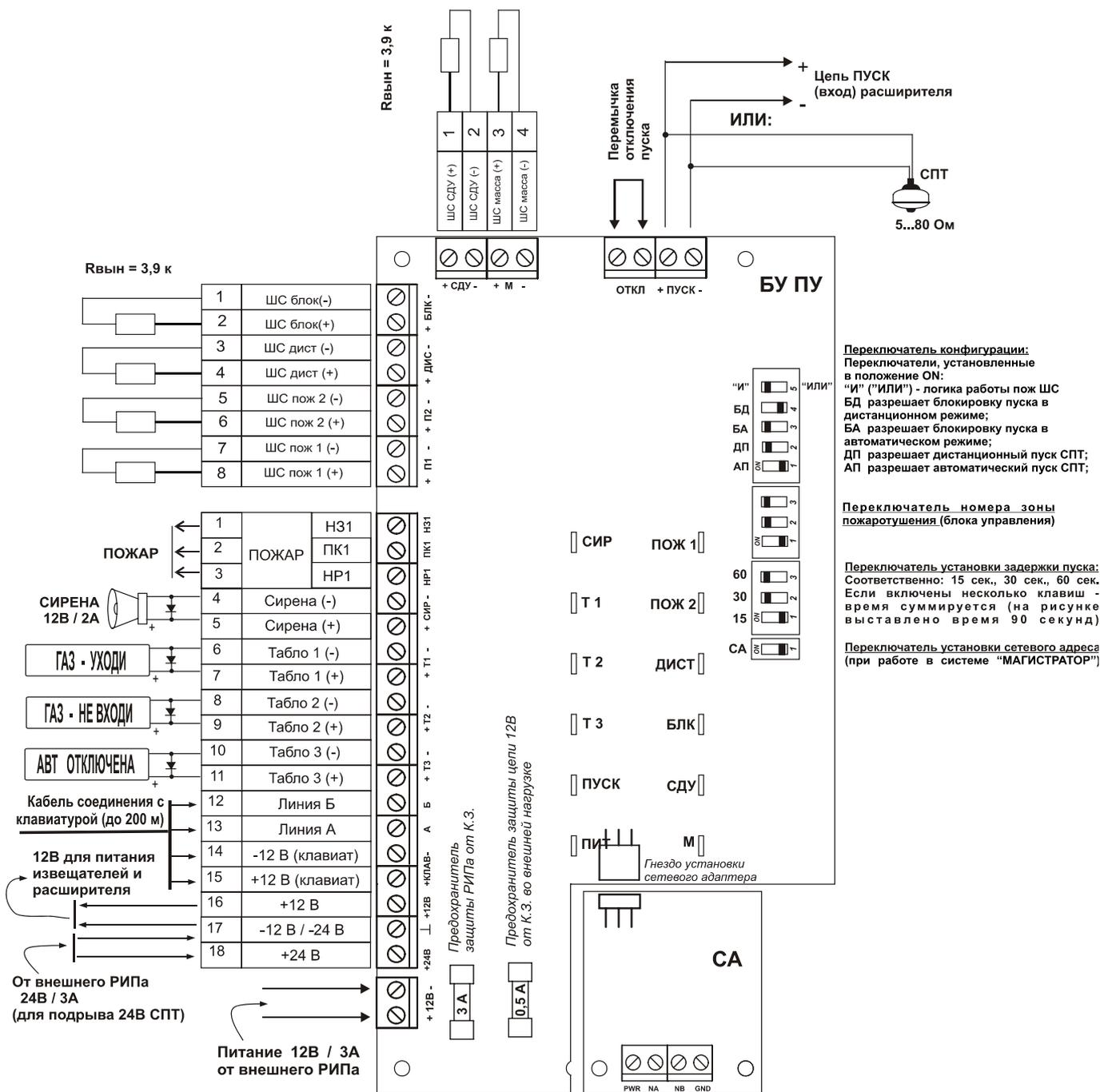
Рис. 5. Схема внешних соединений блока управления с 12В внешним питанием
