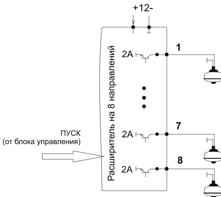
Контроль каждого выхода (направления) на обрыв и К.З.
