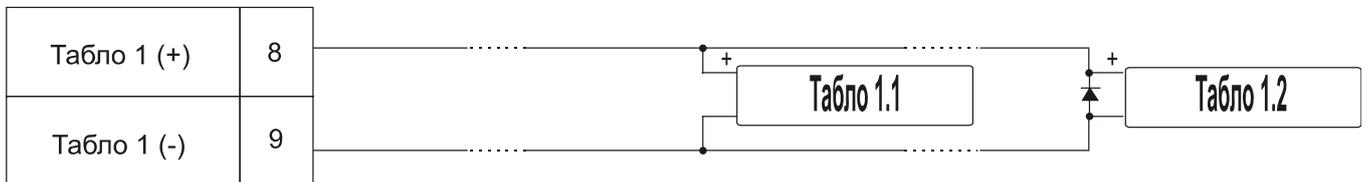
Вариант подключения нескольких оповещателей на примере Табло 1 (диод устанавливается в конце линии на последнем оповещателе!)
