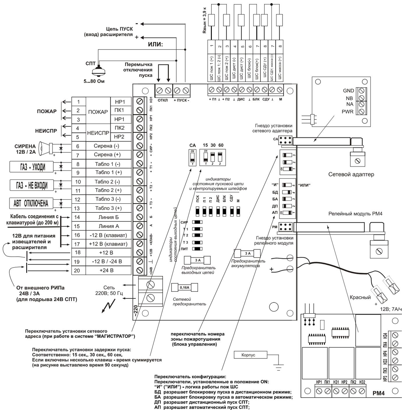
**Примечание:** На схеме указан вариант подключения светодиодных табло и табло со встроенным диодом. При использовании табло на лампах накаливания последовательно с ними необходимо включить диод (например типа 1N4007).
