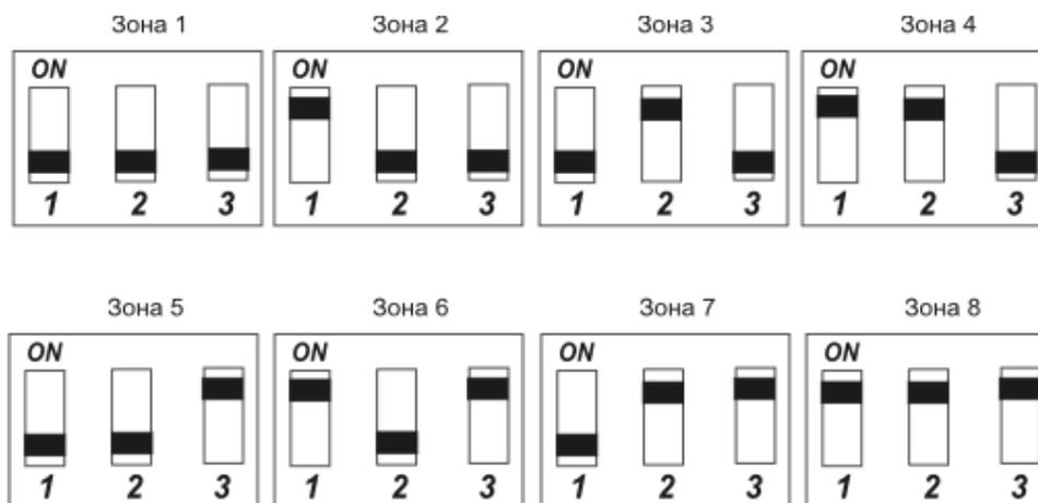
12.3. Конфигурация блока управления устанавливается переключателем конфигурации:
