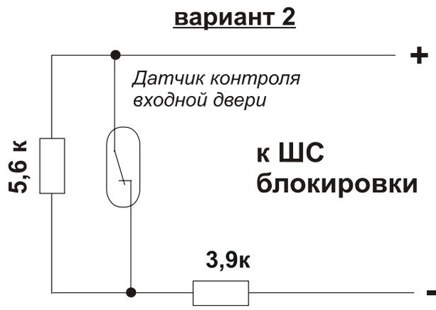
Схема подключения ШС блокировки без фиксации сработки. Восстановление автоматического пуска происходит при восстановлении ШС бл.
