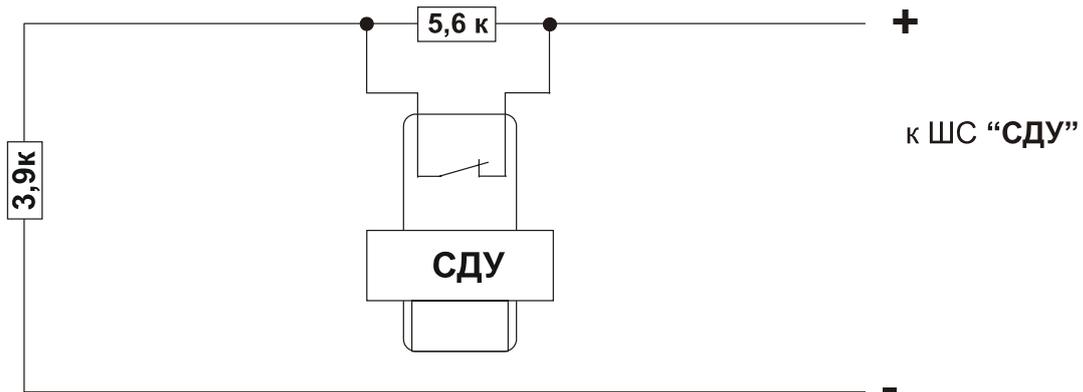
Схема подключения датчика СДУ к ШС "СДУ"
