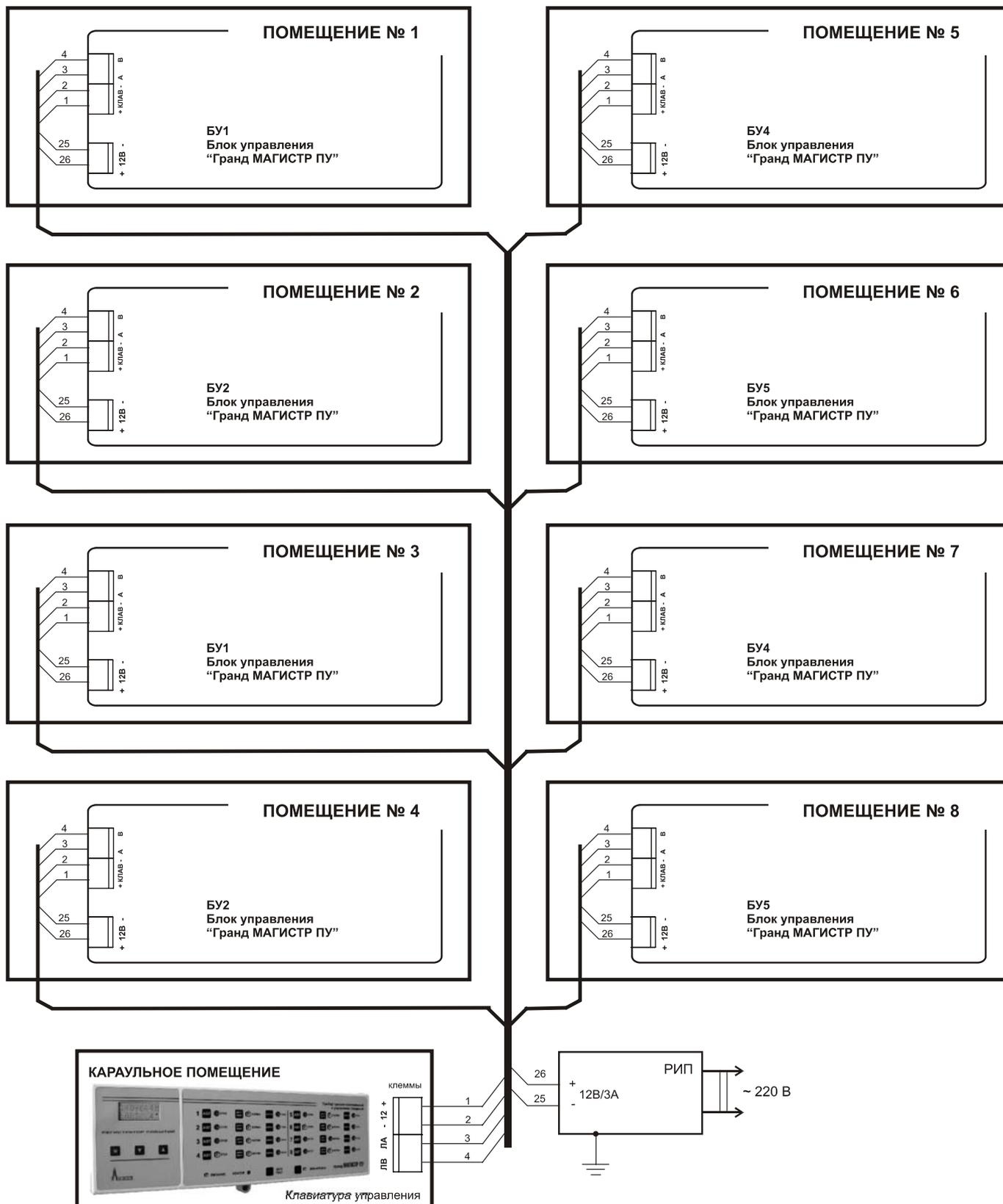
1. Блоки управления соединяются между собой и клавиатурой по одному 4-проводному кабелю.
