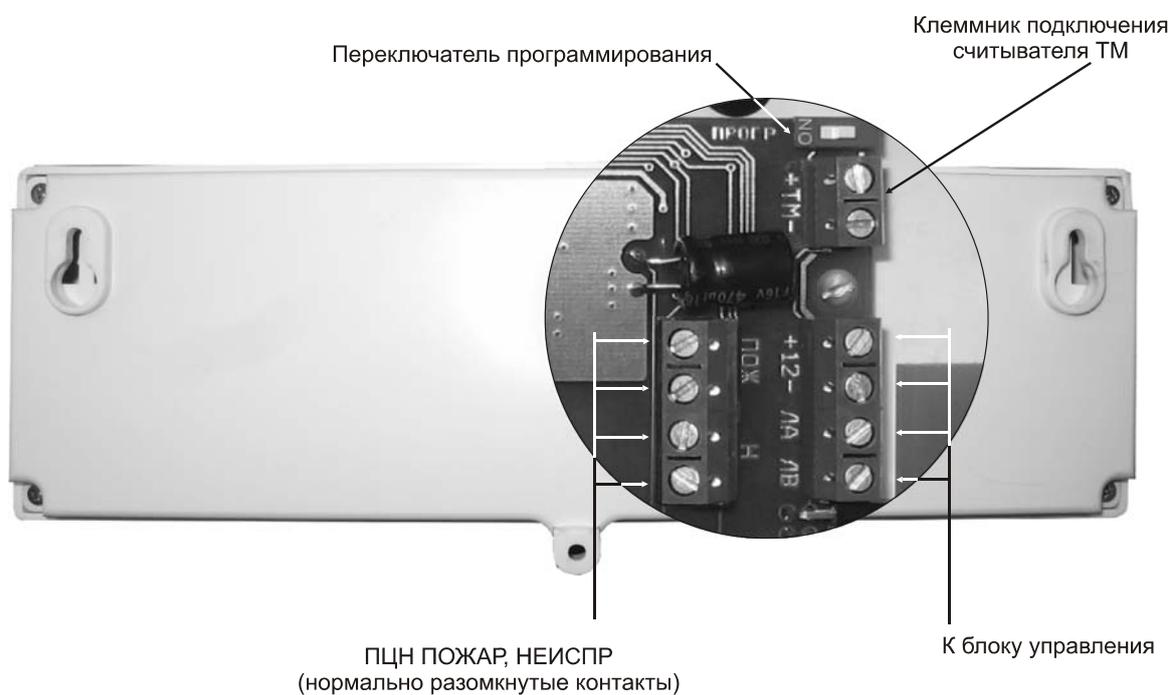
Рис. 1. Внешний вид и схема внешних соединений клавиатуры прибора "Гранд МАГИСТР ПУ"
