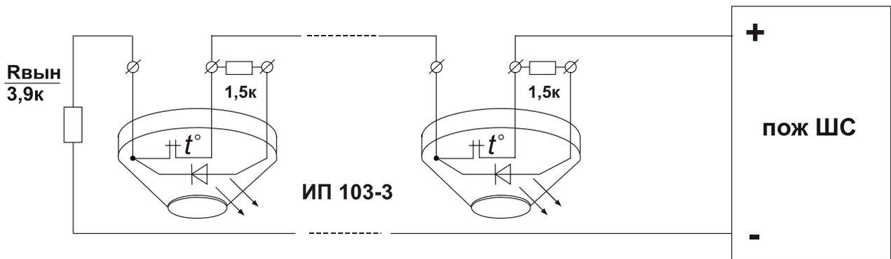
**Комбинированная схема подключения дымовых и тепловых извещателей к пожарному ШС (со сработкой по 2 датчикам одного типа)**
