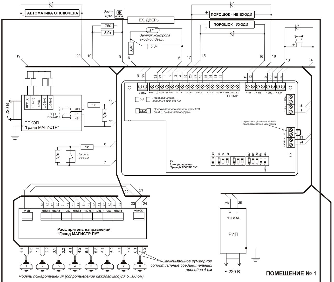
1. При отсутствии какого-либо из контролируемых шлейфов между соответствующими клеммами блока управления устанавливаются оконечные резисторы 3,9 кОм.
