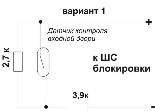
Схема подключения ШС блокировки с фиксацией сработки. Восстановление автоматического пуска происходит при нажатии на кнопку СБРОС (при условии восстановленного ШС бл.)
