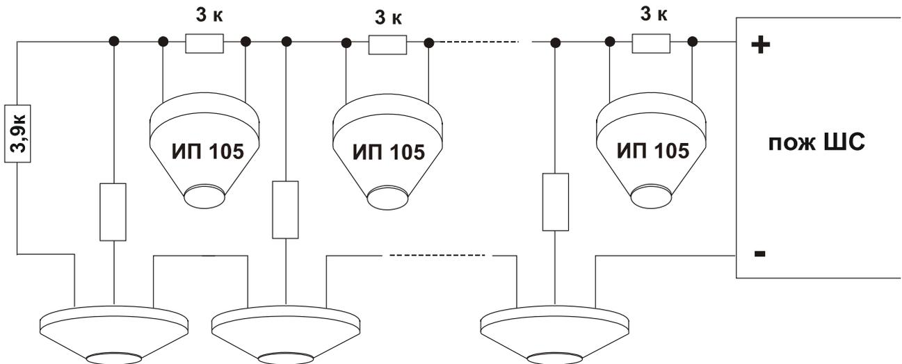
Рис.8.2. Схемы подключения шлейфов сигнализации к блоку управления
