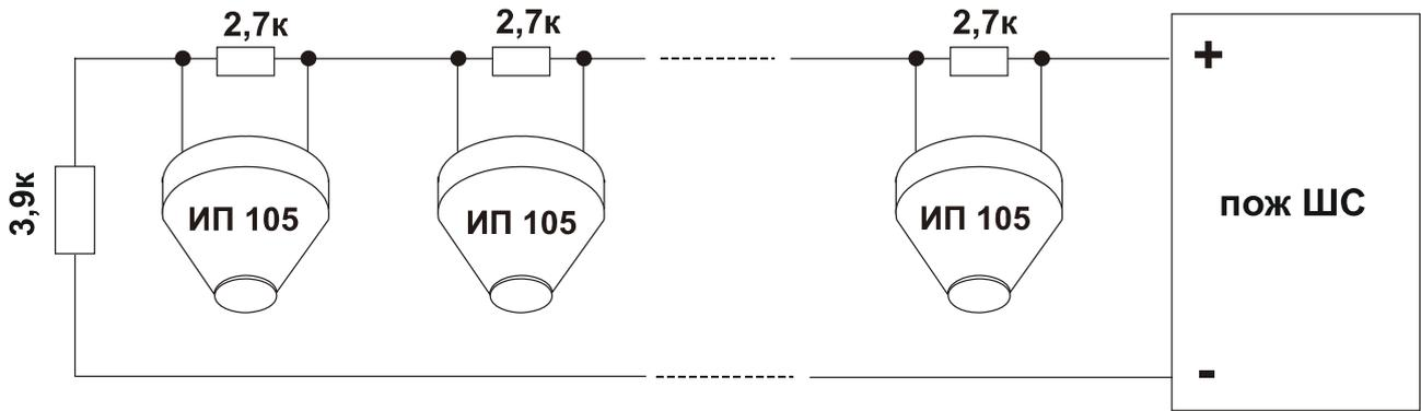
**Схема подключения тепловых извещателей типа ИП 103-3 к пожарному ШС**
