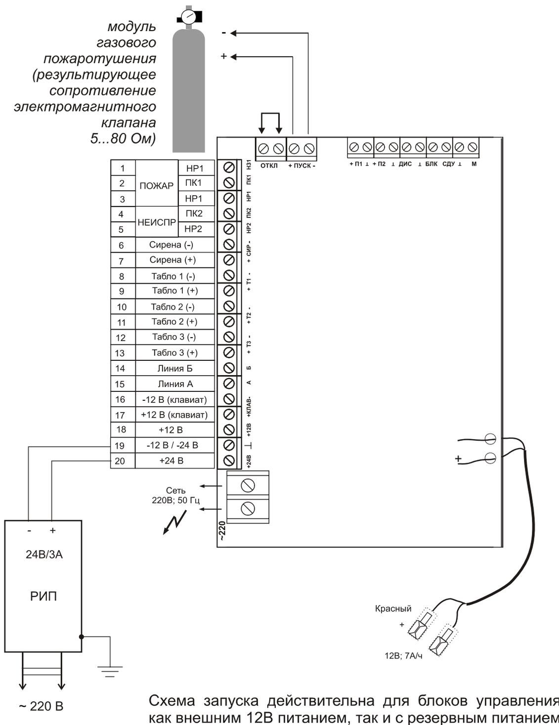
Рис. 8.5. Схема подключения дополнительного РИПа для организации пуска СПТ напряжением 24В
