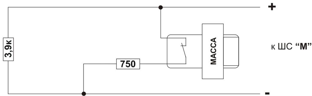
Схема подключения датчика контроля массы к ШС "М"
