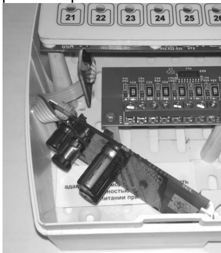
Рис. 3. Установка и подключение модуля SMS
